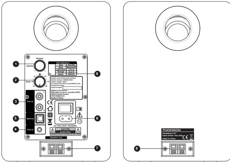
1 – Ajuste del volumen / Selección de la entrada/encendido/apagado
